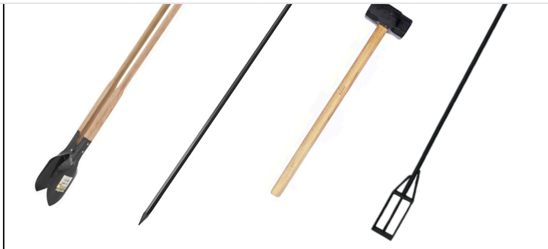
Figura 1 – Exemplo de ferramentas (cavadeira, alavanca, marreta e socador manual)
