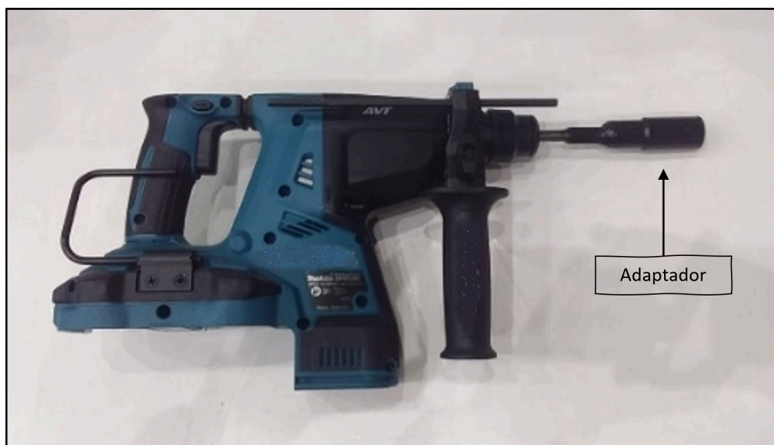
Figura 6 – Soquete adaptador acoplado ao martetele
